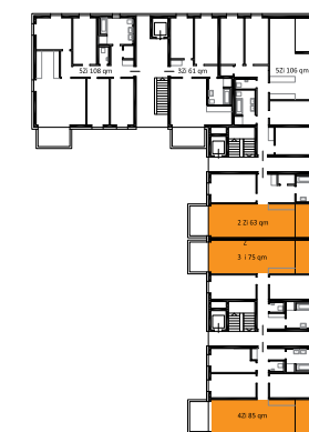
Regelgeschoss Winkelbau: Durchwohngrundrisse
